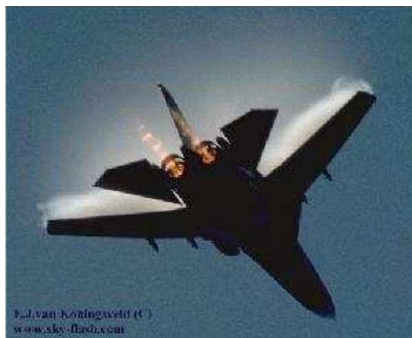
Obrázek 4: I tento jev, způsobený prouděním okolo křídla letounu, lze popsat Navierovými-Stoeksovými rovnicemi.
