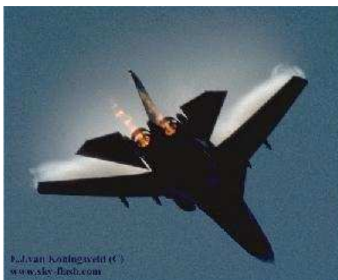
Obrázek 2.4: I tento jev, způsobený prouděním okolo křídla letounu, lze popsat Navierovými-Stokesovými rovnicemi.
