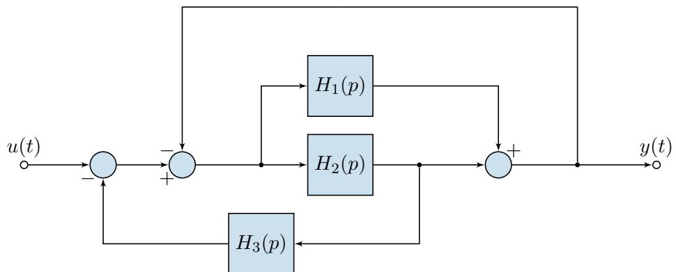
$$\text{Řešení: } \left[ H(p) = \frac{H_1(p) + H_2(p)}{1 + H_1(p) + H_2(p) + H_2(p)H_3(p)} \right]$$
