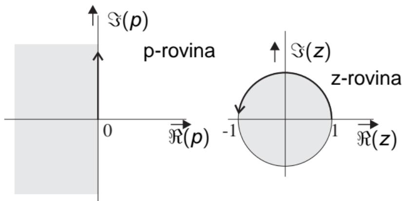
Obrázek: Zobrazení roviny  $p$  na rovinu  $z$  při transformaci
