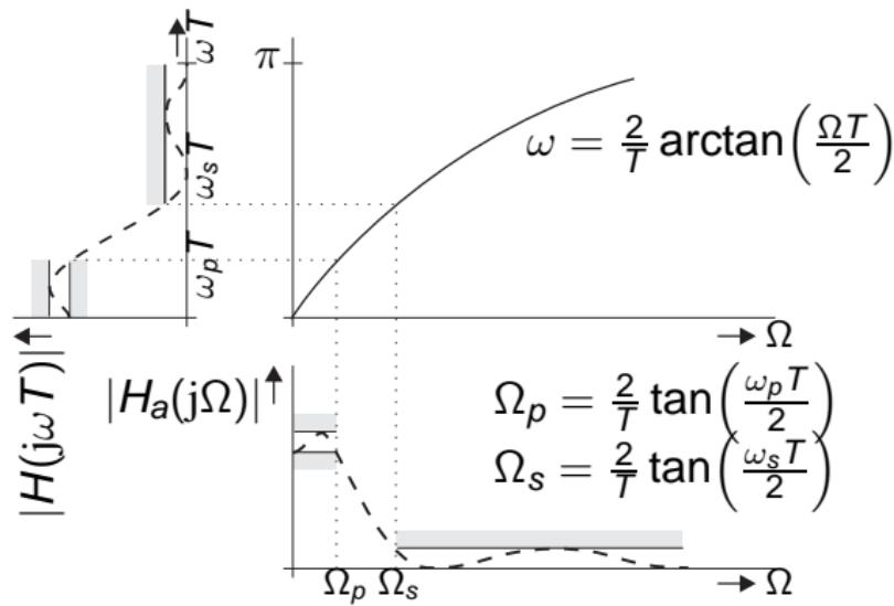
Obrázek: Zkreslení kmitočtových os při bilineární transformaci analogového dolní propusti na číslicovou dolní propust.
